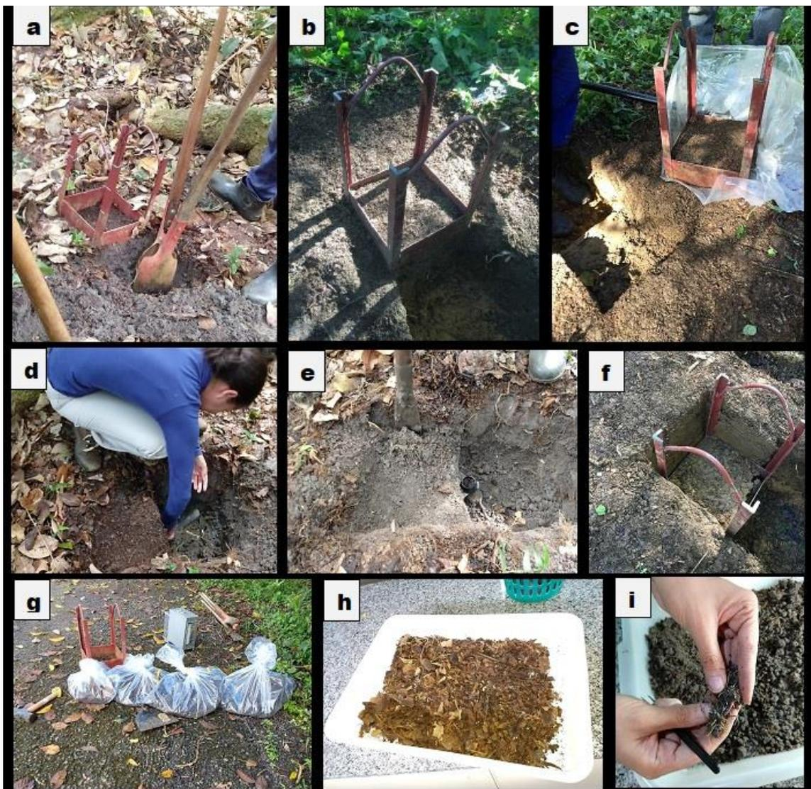
**Figura 3.** Procedimentos de coleta (TSBF) e triagem do material coletado. (a) Demarcação da área (25x25 cm) e escavação ao lado da amostra para a retirada dos monólitos. (b) Delimitando a camada 0-10 cm para a sua retirada e depósito no saco plástico (c). Medição dos próximos 10 cm com uma régua (d), para coletar a camada 10-20 cm com ajuda de uma enxada na base (e). (f) Quadro de metal na camada 20-30 cm de profundidade.
